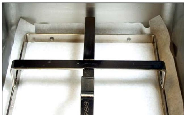
**Si vous utilisez le papier-filtre, placez l'anneau de maintien sur le papier-filtre et abaissez l'anneau dans le bac pour permettre au papier de se replier autour de l'anneau lorsqu'il est poussé au fond du bac. Une fois l'anneau de maintien en position, saupoudrez une tasse de poudre à filtre uniformément sur le papier.**
