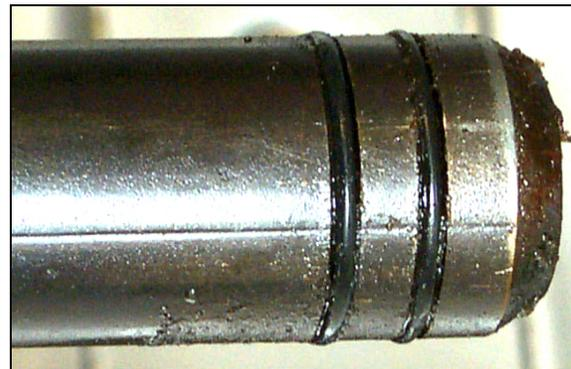
**Inspectez les joints toriques du raccord du filtre.**
